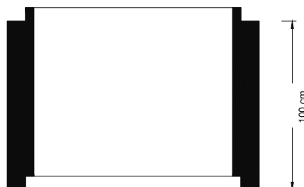
Anillo de pozo Peso por unidad: 800 kgs. Espesor: 160
